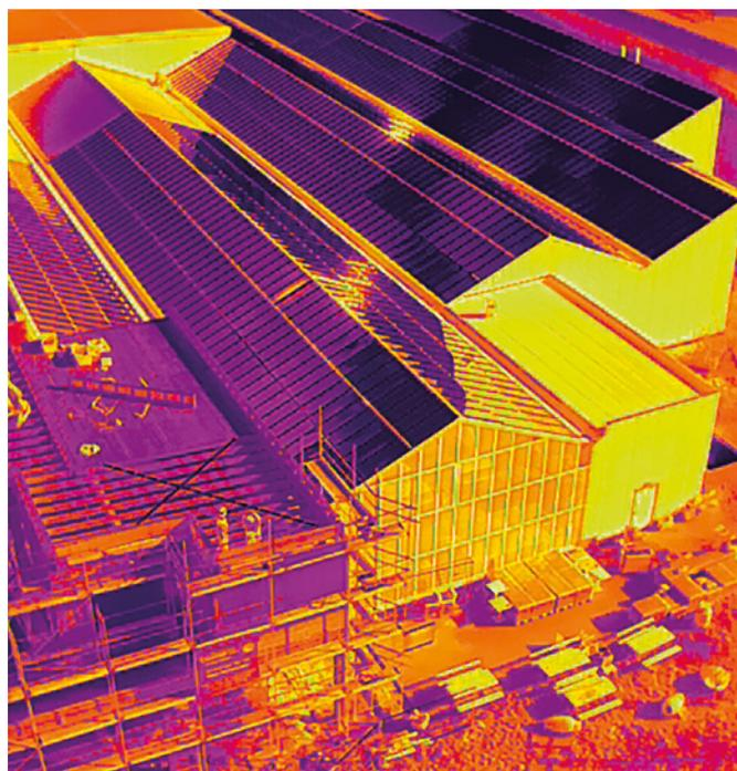
*Photo aérienne d'une jardinerie – et la même photo en cliché thermoscan : combinaison de photogrammétrie et de thermographie assistée par drone – une technologie innovante pour la localisation précise des fuites et l'optimisation énergétique.*
