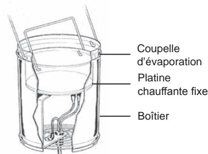
**Image ci-dessus :** schéma de construction d'un évaporateur à platine
