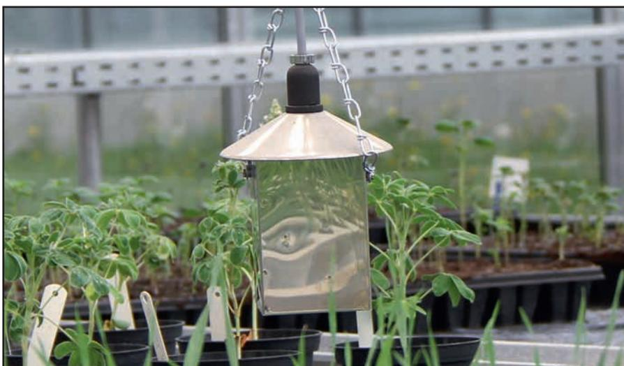
Photo 5 : Sonde thermique avec protection anti-rayonnement. Alors que les sondes doivent être judicieusement suspendues pour la régulation, les capteurs d'alarme peuvent être installés à l'endroit le plus favorable pour une surveillance rapide des valeurs contrôlées. (Photo : RAM)
