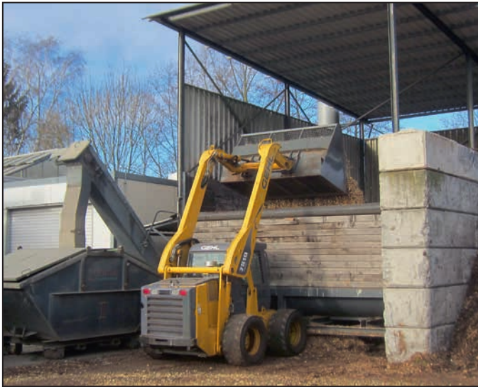
Photo 3 : Chargement du silo à combustible par chargeur à roues Photo 4 : Stockage de paille
